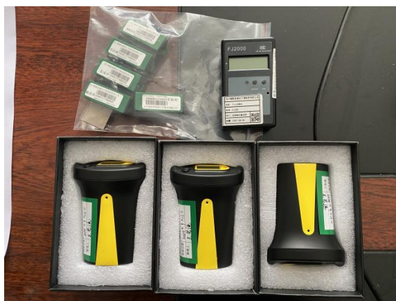
图 3-4 本项目配备的个人剂量报警仪及个人剂量计
