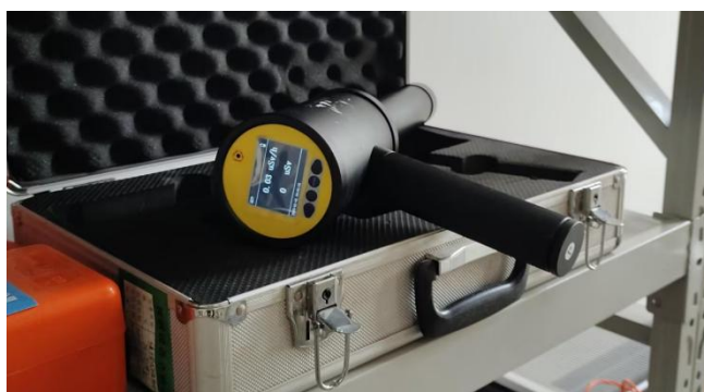
图 3-5 本项目配备的便携式辐射剂量监测仪
